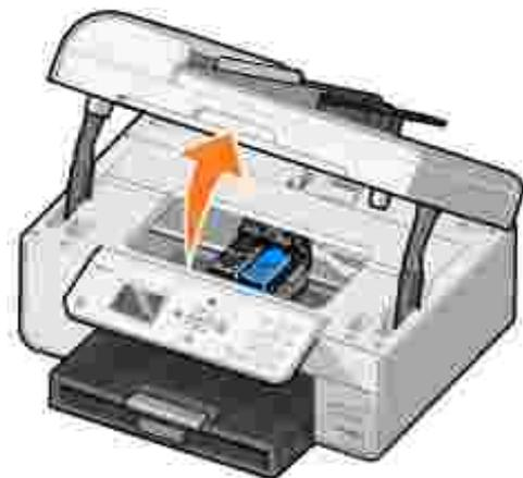
印刷中でなければ、カートリッジキャリアが取り付け位置まで移動して停止します。
