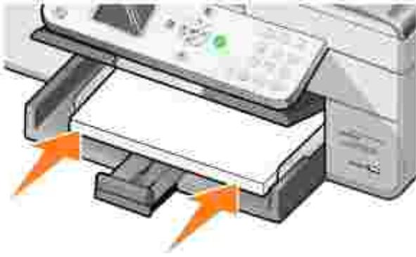
3. レバーをつまみながら用紙ガイドをスライドさせて、用紙の左端、右端、および下端に合わせます。
